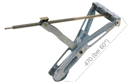
Steckstützen Plus 1000 S Tragfähigkeit: 1000 kg; zul. Gewicht: 2000 kg; Gewicht: 4,2 kg Herst.-Nr.: 1224509 Art-Nr. 120/004
