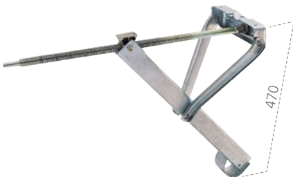
AL-KO Steckstützen Tragfähigkeit: 800 kg; zul. Gewicht: 1600 kg; Gewicht: 3,4 kg Herst.-Nr.: 1224508 Art-Nr. 120/002
