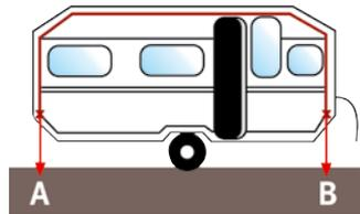
Messen Sie das Umlaufmaß Ihres Caravans auf ebener Fläche und bei stehendem Fahrzeug, in­dem Sie eine Kordel (A) durch die Kederleiste wieder zum Erdboden (B) führen.
